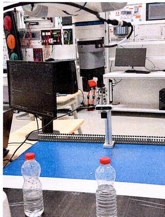
Figura 55. Detektimi i objektit, përgatitja e robotit për lëvizje dhe roboti duke u pozicionuar mbi objektin
