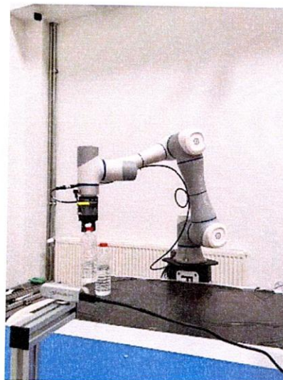
Figura 58. Zhvendosja e objektit drejt destinacionit të përcaktuar dhe lëshimi i objektit dhe përfundimi i procesit pick-and-place
